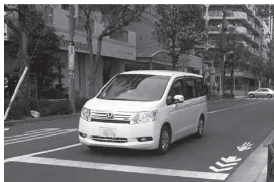
写真④ 車道幅に余裕のある場所では、自転車がいなくてもほとんどのクルマが、自転車ナビマークを見て左側を空けて走行していた
