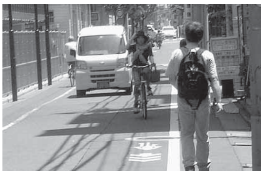
写真⑥ 自転車ナビマークが路側帯外側の車道上に設置されたことで、車道内で自転車とクルマがスペースを譲り合って走行していた
